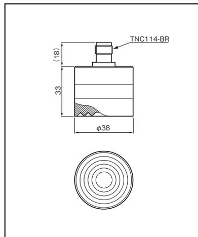
水道管からの漏水音の聴音用
