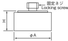
**【ご注意】**マグネットホルダーの吸着力は非常に強く、僅か10mmの距離から吸着させただけで、センサには10,000m/s<sup>2</sup>以上の衝撃加速度が加わります。そのためセンサが故障することがありますので、マグネットホルダーの端部を一旦対象物に当てた後、手を離さずに静かに設置してください。
