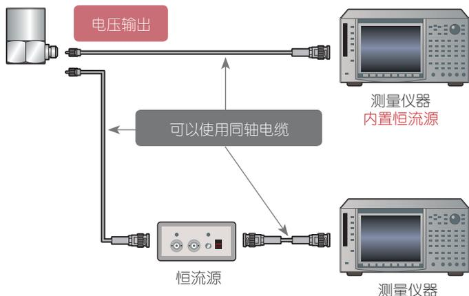
某些加速度传感器内置了前级放大器，内置的放大器可以将传感器的信号转换为低阻抗的电压信号，因此不再需要外接电荷放大器。这种传感器需要采用恒流源供电，通常电流为0.5到5毫安，15伏至25伏直流电压。
