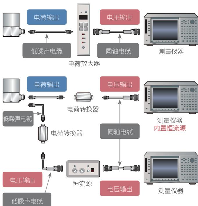
电荷输出型加速度传感器输出的是高阻抗的电荷信号。在送到测量仪器之前需要将其转换为低阻抗的电压信号。
